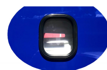
車外 非常扉開閉レバー
