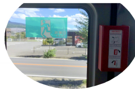
車内 非常扉開閉レバー
